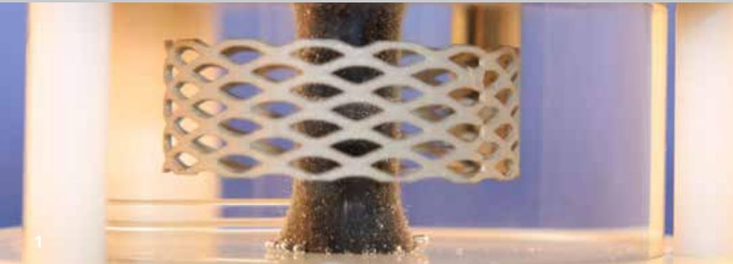
1 *Elektrochemische Zelle zur in-situ Erzeugung von Wasserstoff während der zyklischen Werkstoffanalyse*
