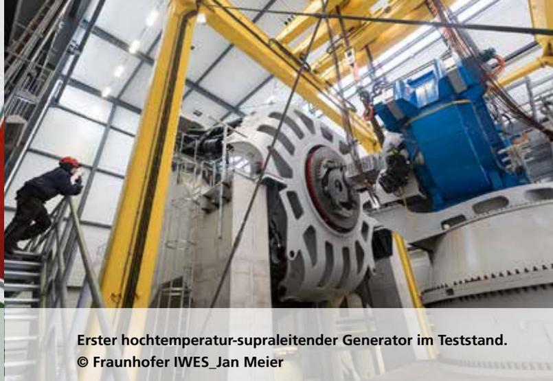
Erster hochtemperatur-supraleitender Generator im Teststand. © Fraunhofer IWES\_Jan Meier
