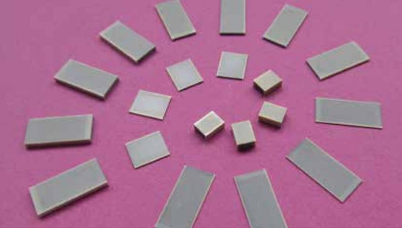
**Gesinterte Mehrlagenstrukturen zum Einsatz in elektrokalischen Wärmepumpen.** © Fraunhofer IKTS
