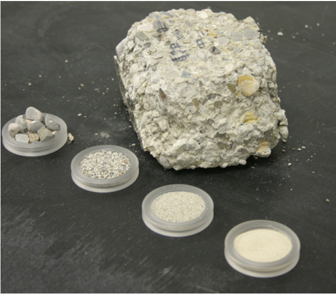
Vorher, nachher: Die Betonprobe, feinsäuberlich in ihre Bestandteile aufgetrennt. Die erhaltenen Kornfraktionen werden nach der elektrodynamischen Fragmentierung getrocknet und gesiebt. © Fraunhofer IBP
