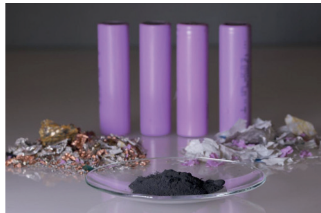
Batteriezellen vom Typ 18650 und aufkonzentrierte Materialfraktionen: Metalle, Kunststoffe und Schwarzmasse. © Fraunhofer-Projektgruppe IWKS
