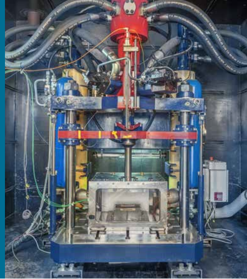
Der Batterieprüfstand zur dynamischen Prüfung von geladenen Zellen. © Fraunhofer EMI
