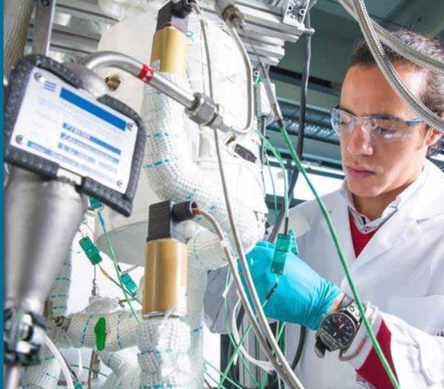
Miniplant-Anlage des Fraunhofer ISE zur Synthese flüssiger Kraftstoffe wie Methanol aus CO 2 und H 2 . © Fraunhofer ISE
