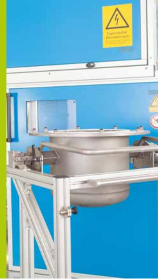
Elektrohydraulische Zerkleinerungsanlage im Technikum der Projektgruppe IWKS zur phasenselektiven Auftrennung von Recyclinggut. © ImpulsTec GmbH
