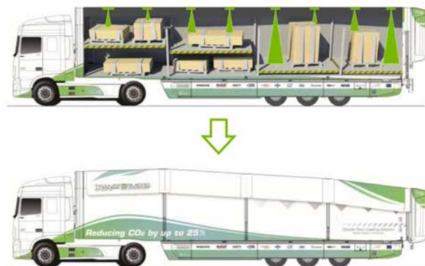
Ermittlung der Ladungshöhe (oben) und Anpassung der Dachhöhe (unten) Grafik: Fraunhofer LBF
