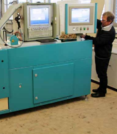
Abbildung 1: NIR-Sortieranlage zur Bestimmung von organischen Holzschutzmitteln.
