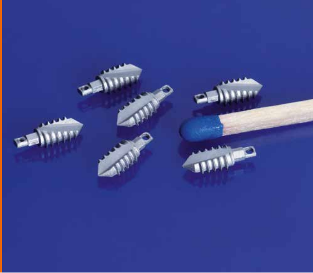
Mittels Pulverspritzguss hergestellte Schulteranker aus Eisen-Tricalciumphosphat-Komposit. © Fraunhofer IFAM
