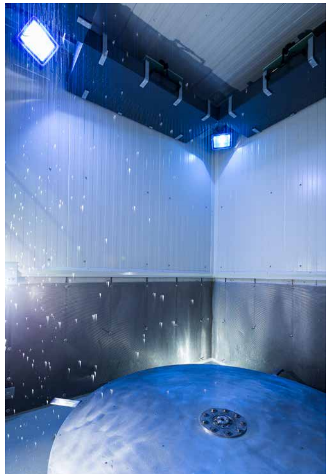
Im Regenerosionsprüfstand werden Materialproben bei variabler Drehgeschwindigkeit, Tropfengröße, Wassermenge und Temperatur getestet. © Jan Meier
