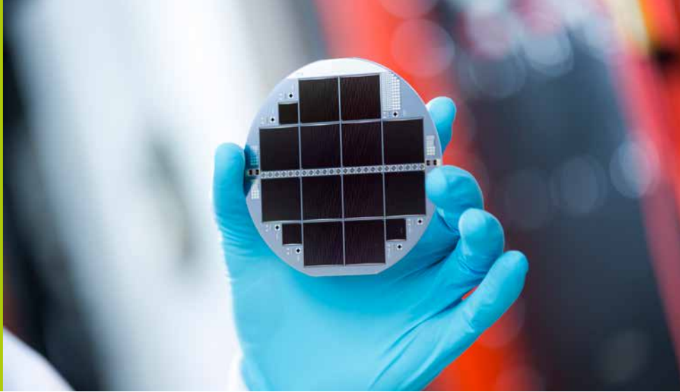
Mehrfachsolarzelle aus III-V-Halbleitern und Silicium, die 33,3 Prozent des Sonnenlichts in Strom wandelt. © Fraunhofer ISE/Dirk Mahler
