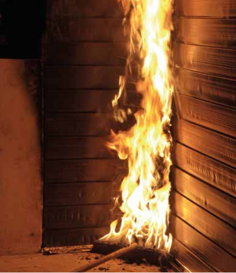
Fassadenprofil während des SBI-Tests.
