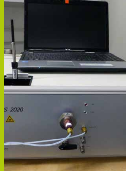
Abbildung 2: GC-FAIMS und dazugehöriges Spektrum, das die Detektion von PCP in behandelten Holzfenstern vor und nach der Oberflächendeckung zeigt.
