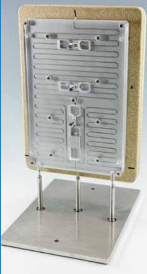
Modularer Hochtemperatur Reaktor für die kontinuierliche Synthese von Nanopartikeln. © Fraunhofer IMM
