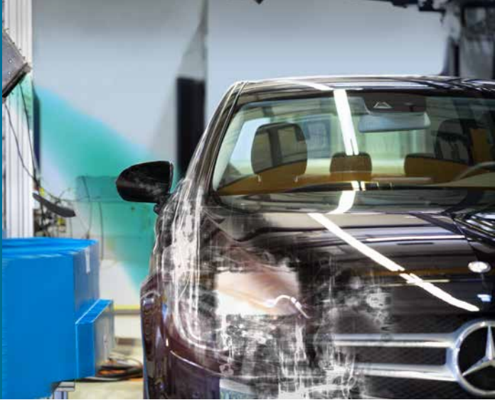
Der Aufbau zum Röntgentest am Fraunhofer EMI in Efringen-Kirchen. © Fraunhofer EMI
