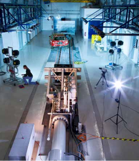
Die Gesamtfahrzeug-Crashanlage am Fraunhofer EMI in Efringen-Kirchen. © Thomas Ernsting
