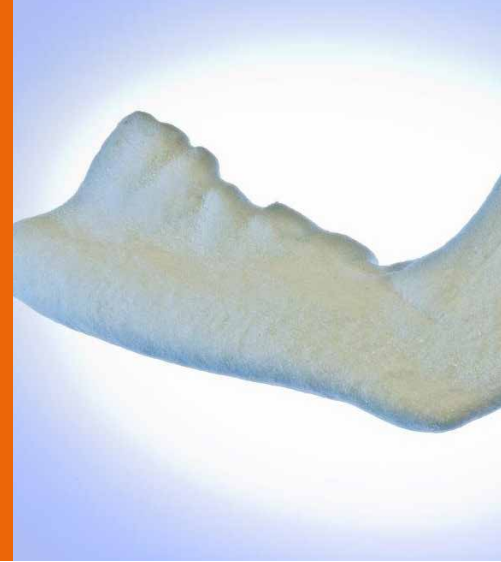
Additiv gefertigter Unterkieferknochen. © Fraunhofer IKTS
