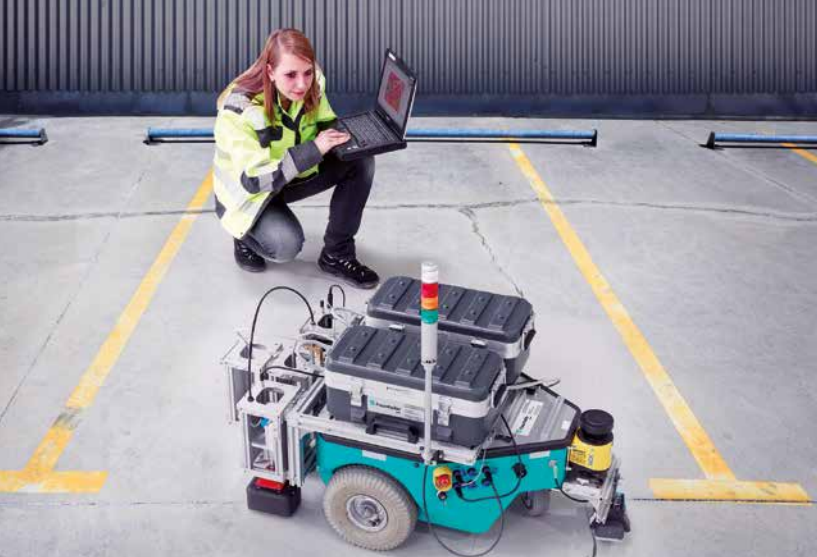
BetoScan - selbstnavigierender Roboter für schnelle Scans großer Betonflächen. © Fraunhofer IZFP
