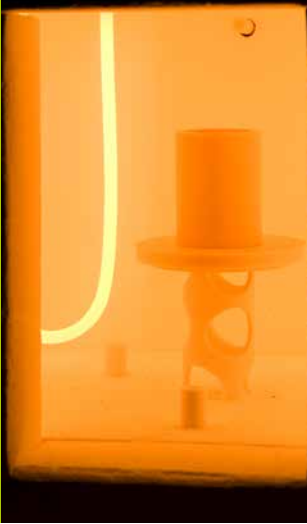
In-situ-Messung von Sintervorgängen in thermooptischer Messanlage – Messbild zur Analyse der Dimensionsänderung. (rechts) © Fraunhofer ISC/Zentrum HTL
