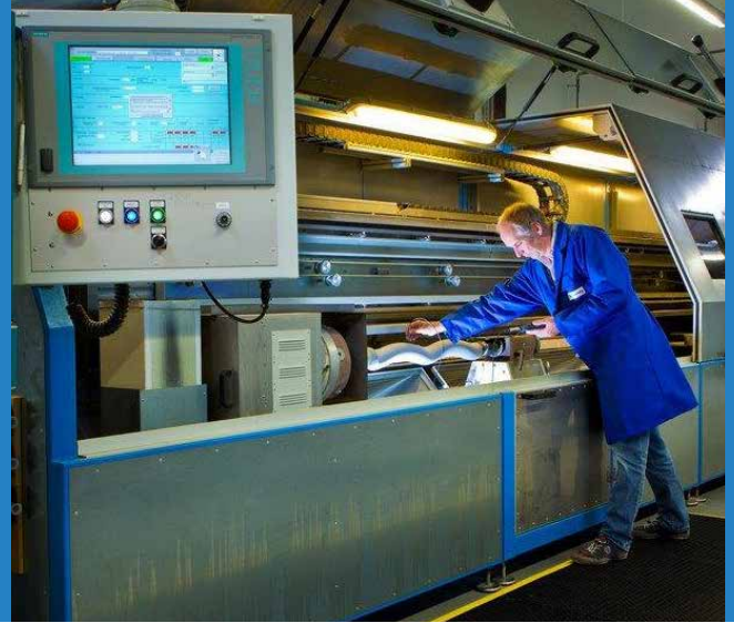
Veredelung von CFK-Bauteilen mittels Plasmaspritzen. © Fraunhofer IKTS
