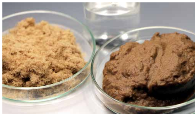
Die Ausgangsstoffe für den Holzschaum: Holzfasern und Wasser werden zu einer Suspension aufgemahlen und aufgeschäumt.
