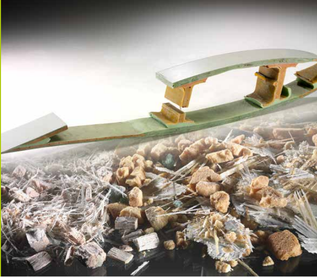
Rotorblattcomposite im Verbund als Querschnitt (oben) und zerkleinert (unten). © Fraunhofer ICT
